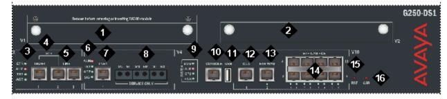
Figure 30: G250-DS1 Branch Gateway Chassis
